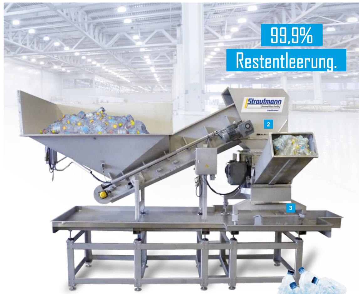
LiquiDrainer® Befüllung per Förderband mit erhöhter Aufstellung.
