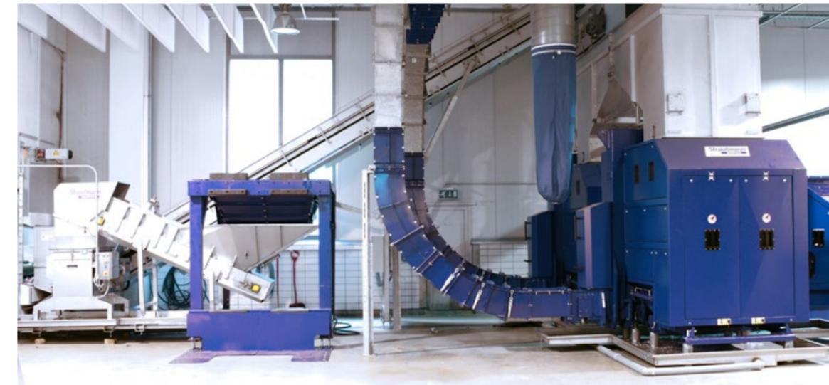
LiquiDrainer® Entwässerer mit vollautomatischer Brikettierpresse.
