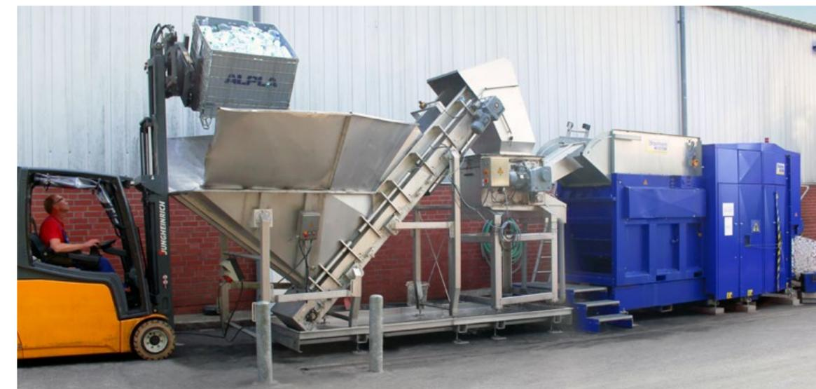
LiquiDrainer® Entwässerer mit vollautomatischer Ballenpresse.
